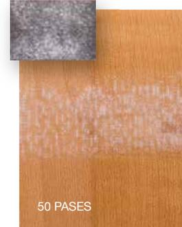
Nuestra mezcla patentada de partículas de óxido de aluminio se suspende uniformemente a través de la capa superior de uretano, lo que brinda la mejor resistencia a la abrasión de la industria. (Resultados después de 50 mil pasadas con bloque de lijado.)
