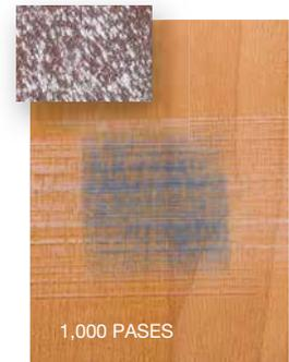
Con nuevos compuestos protectores de la industria aeroespacial y la odontología, la resistencia a las manchas de Quantum Guard Elite se desempeña con el mismo nivel de calidad con el tiempo. nivel como el día en que se instaló. (Resultados después de 1000 pasadas con un bloque de lijado y limpieza con una toallita con alcohol).
